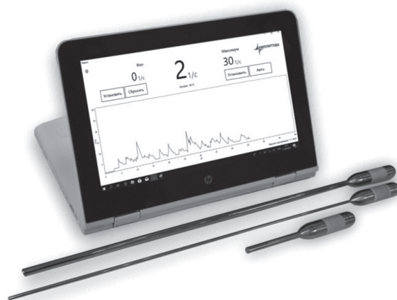
Рис. 2. Беспроводное гамма-детектирующее устройство для поиска сторожевых лимфоузлов «Радикал» (НТЦ «Амплитуда», РФ)
